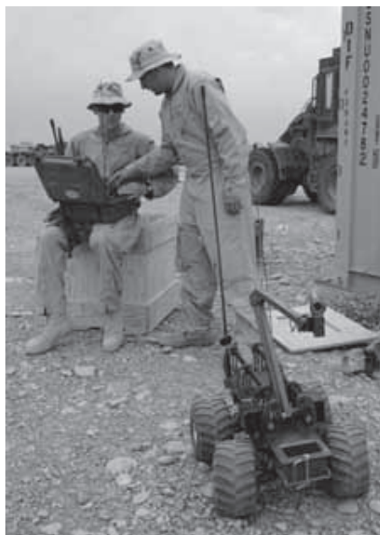
Obrázok č. 2: robot MARCbot s príslušníkmi armády USA, zdroj: US NAVY, Security-Magazin online
