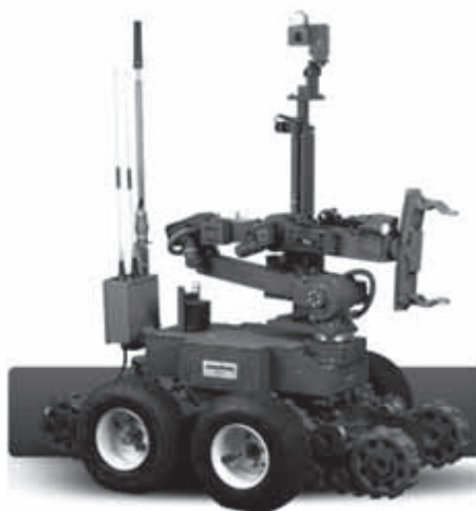
Obrázok č. 1: EOD robot ANDROS Mark V-A1, hmotnosť 358 kg, max. rýchlosť 5,6 km/h, cena 180 000 USD, zdroj: AZoRobotics Datasheet
