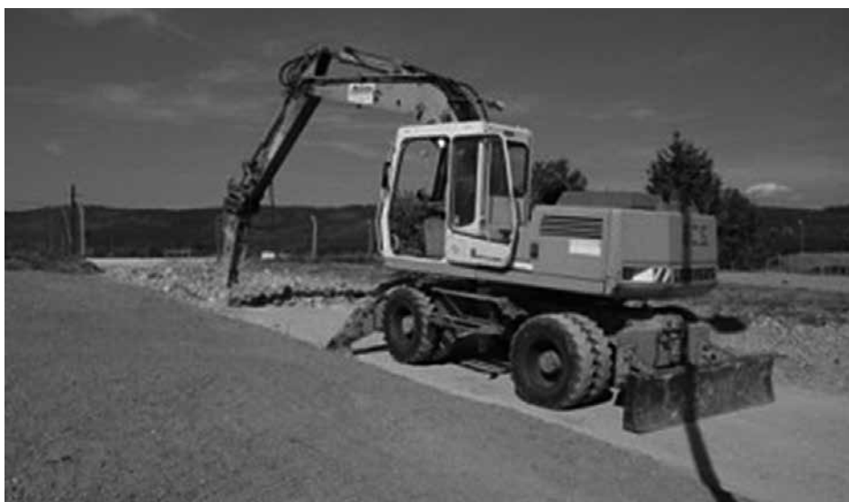
Obrázek č. 5: Pronajatý prostředek místní firmy pro likvidaci dočasných komunikací ze železobetonu.
