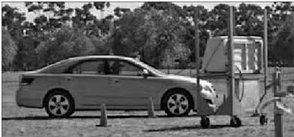
Obr. č. 19: Testování zastavování vozidel s využitím EMP 39
