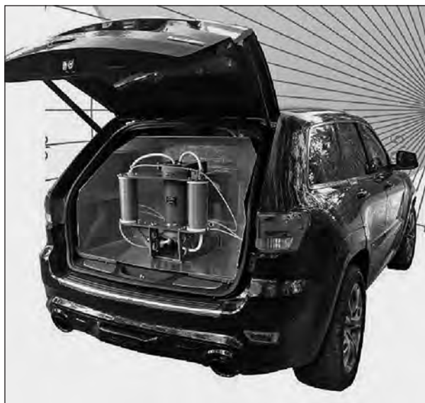
Obr. č. 11: Systém zastavování vozidel HPEMcarStop 26
